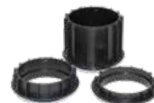
Éléments de surélévation Elefeet® A 12, A 22 et A 67, combinables de multiples façons en continu jusqu'à une hauteur d'env. 500 mm
