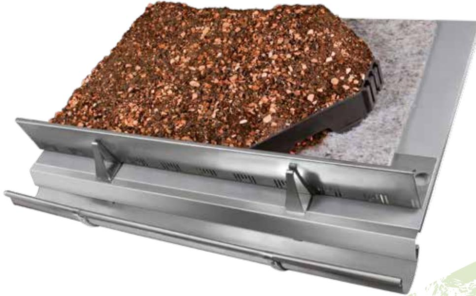
Avec le système de toit végétalisé en forte pente présenté ci-contre, ayant pour base les éléments ZinCo Georaster®, la végétalisation des toitures inclinées à plus de 25° devient possible. Les éléments Georaster® en polyéthylène recyclé (PEHD) s'emboîtent les uns dans les autres sans outil particulier. Assemblés, ces éléments d'env. 54 × 54 cm pour 10 cm de haut forment immédiatement une structure stable et solide sur toute la surface.
