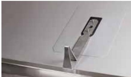
L'association du Schubfix LF 300 en acier inoxydable avec les profils de rive ZinCo remplace les traverses anti-poussée en matériaux dérivés du bois. Il est parfait pour les toits à faible pente. Résistance par support : 300 kg
