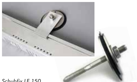
Schubfix LF 150 L'ancre à visser LF 150 en acier inoxydable, en deux parties, s'utilise lorsque la charge par point de maintien n'excède pas les 150 kg. L'idéal pour fixer les arrêts de gravier au moyen d'une tôle de maintien.
